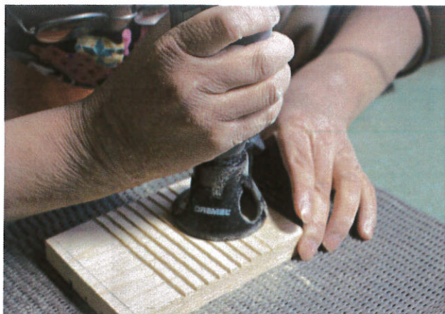
洗濯板の溝を作る工程。その後は、やすりがけ。すべて手作業です。
